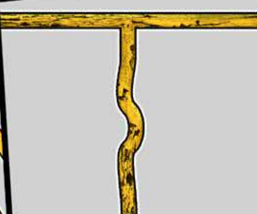
PERFILES CON CORROSIÓN O DOBLADOS
