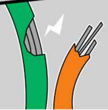
CABLES ELÉCTRICOS EN MAL ESTADO
