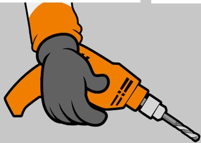
TRASLADAR TALADROS CON LA BROCA PUESTA, AL IGUAL QUE ESMERILES CON EL DISCO INSTALADO
